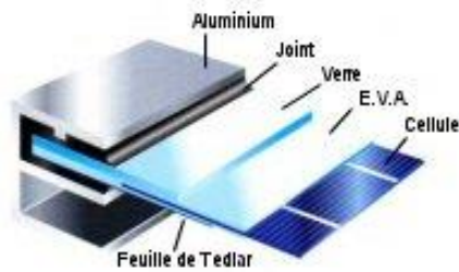
Illustration 2: Agencement d'un module photovoltaïque cristallin
